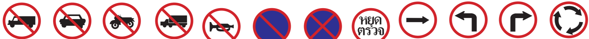
1-9 ห้ามรถบรรทุก 1-10 ห้ามรถยนต์ 1-11 ห้ามรถ จักรยานยนต์ 1-12 ห้ามรถพ่วง 1-21 ห้ามใช้เสียง 1-22 ห้ามจอด 1-23 ห้ามหยุดรถ 1-24 หยุดตรวจ 1-33 รถเดินทางเดียว ไปทางขวา 1-34 ให้เลี้ยวซ้าย 1-35 ให้เลี้ยวขวา 1-36 วงเวียน
